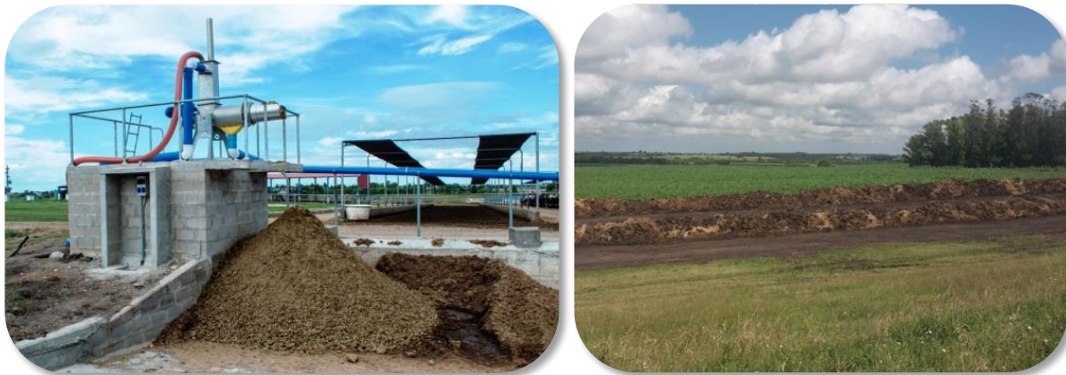
Figura 2. Separador mecánico de sólidos y compostaje del sólido separado.
